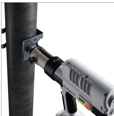
Abb. 19: Den Einpressanschluss mithilfe der Pressmaschine und der Positionierungshilfe mit dem Stahlrohr verpressen. Somit ist die Verbindung zu der Rohrleitung schnell und sauber hergestellt.
