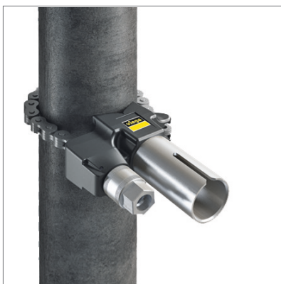
Abb. 17: Die spezielle Bohrvorrichtung zur Führung der Bohrwelle am Stahlrohr (1½–6 Zoll) mittels Ring- oder Maulschlüssel befestigen.
