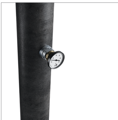
Abb. 20: Fertig ist der Stahlrohranschluss Rp ¾ für Thermometer, Temperatursensor, Manometer, Entleerungen oder Leitungsanschlüsse.
