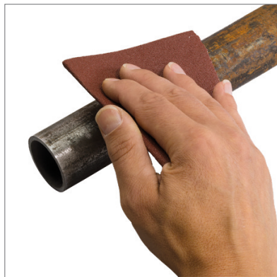
Abb. 30: Bearbeitung mit Reinigungsvlies/Schleifpapier
