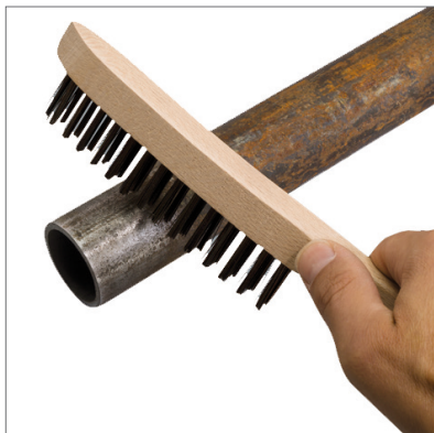
Abb. 29: Bearbeitung mit Drahtbürste
